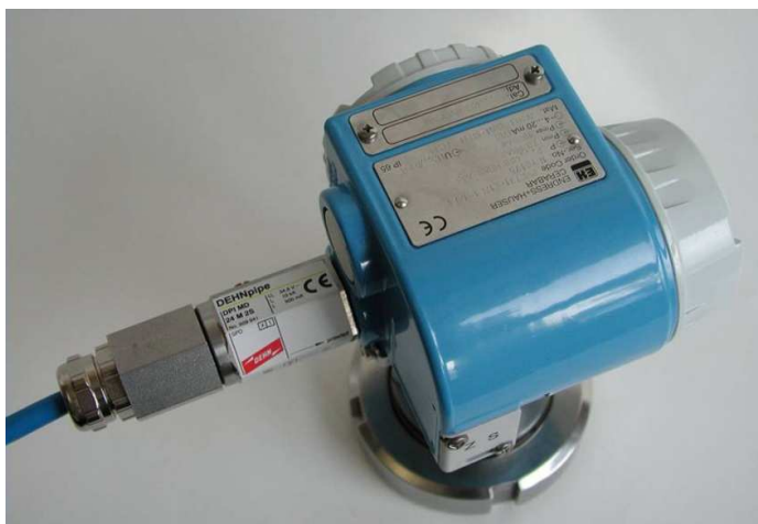
Rys. 6. SPD instalowane bezpośrednio przed przetwornikiem; a) ogólny schemat SPD, b) widok ogólny, c) przykładowe połączenia [17]
